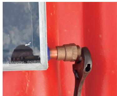
Se perceber que o fluxo de água parece obstruído quando da drenagem, procure a assistência técnica autorizada para limpeza interna especial do equipamento.
